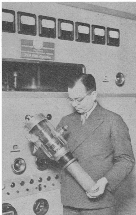
Fig. 4. — El ingeniero Simpson teniendo entre sus manos una válvula RCA-893
